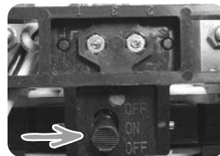
Diafragma-beschermings-schakelaar geactiveerd. (Pomp draait niet.)
